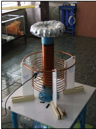
รูปที่ 14 การทดสอบทางกายภาพโดยใช้กรวดล่อที่แรงดันขาออกโดยใส่ทอไรด์ (Toroid)
