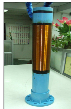
รูปที่ 8 ขดลวดแรงสูงที่พันอยู่กับท่อ PVC ขนาด 4 นิ้ว
