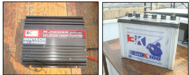
รูปที่ 25 อินเวอร์เตอร์ 950 W และแบตเตอรี่ที่ใช้งานจำนวน 2 ลูก ขนาด 200 Ah (ลูกละ 100Ah)
