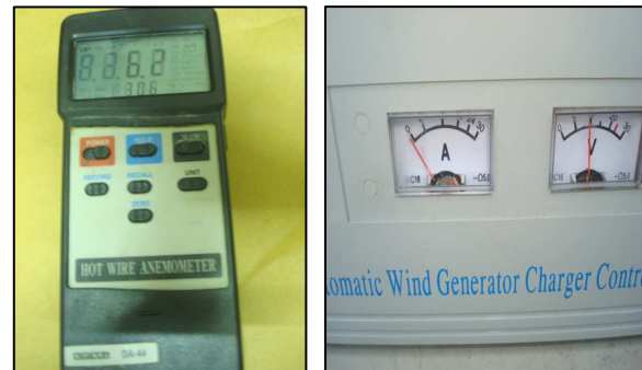
รูปที่ 26 แสดงการวัดลมได้ที่ 6.2 m/s และ แสดงค่าแรงดันที่ได้จากชุด Charger Controller ขนาด 10-15 VDC
