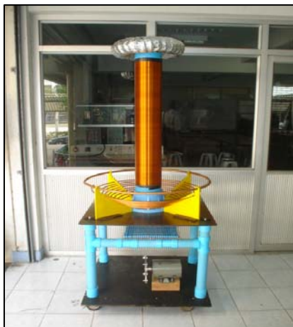
รูปที่ 13 หม้อแปลงทดสอบจากการวิเคราะห์สนามไฟฟ้าเพื่อจำลองการ วางขดลวดปฐมภูมิ ( L_p ) ที่เหมาะสม ที่มุม 30 และ 45 องศา จากการวิเคราะห์สนามไฟฟ้าของทั้ง 4 มิติโดยจำลองสร้าง เป็นหม้อแปลงทดสอบขนาด 350 kV 120 kHz
