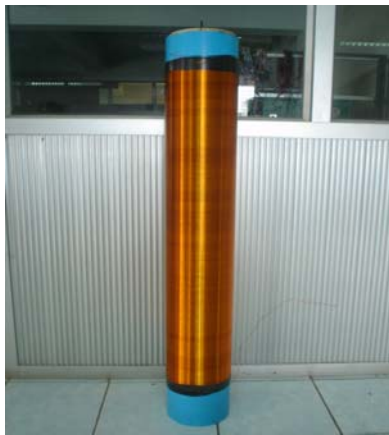
รูปที่ 4 ขดลวดแรงสูงที่พันอยู่กับท่อ PVC ขนาด 6 นิ้ว
