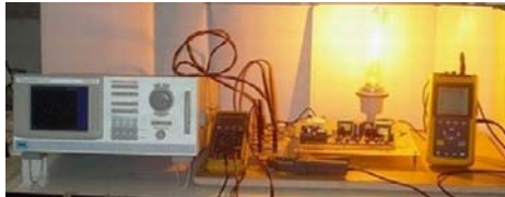
รูปที่ 11 การทดสอบบัลลาสต์อิเล็กทรอนิกส์ต้นแบบสำหรับหลอดโซเดียมความดันสูง 250 วัตต์
