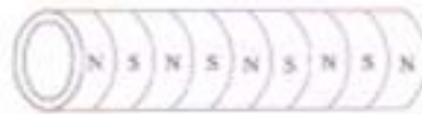
รูปที่ 1 โครงสร้างด้านปฐมภูมิของมอเตอร์เหนี่ยวนำเชิงเส้นแบบทรงกระบอก
