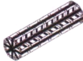
รูปที่ 3 ส่วนปฐมภูมิของมอเตอร์ที่ประกอบแล้ว
